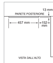
Posizione della conduttura dell'acqua (inferiore).
